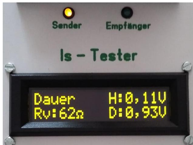
Wenn gar kein Empfänger angeschlossen ist, entspricht dies dem maximalen Dunkel-Wert, der bei 0,96-0,97 Volt liegt. Ein Kurzschluss des Empfängers entspricht dem minimalen Hell-Wert von 0 Volt.
