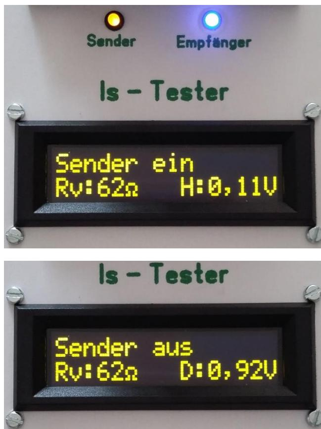
Die blaue LED kann blinken, dauerhaft an oder aus sein. Sie signalisiert damit, in welchem Spannungsbereich sich der aktuelle Messwert befindet.
